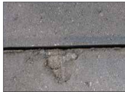
Øverst ses revner i overfladen som følge af fejl i støbningen eller håndteringen. Nedenunder et eksempel på mangelfuld fyldning af formen, der har givet en fordybning i kanten af flisen, skal sorteres fra før lægningen.
